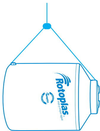
Fig.1. Detalle de la elevación del tanque a la azotea.
